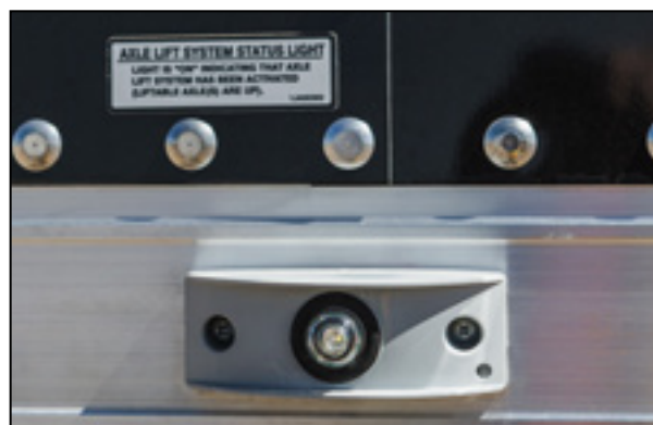
Figure 24 – Voyant et autocollant du système d'essieu relevable
