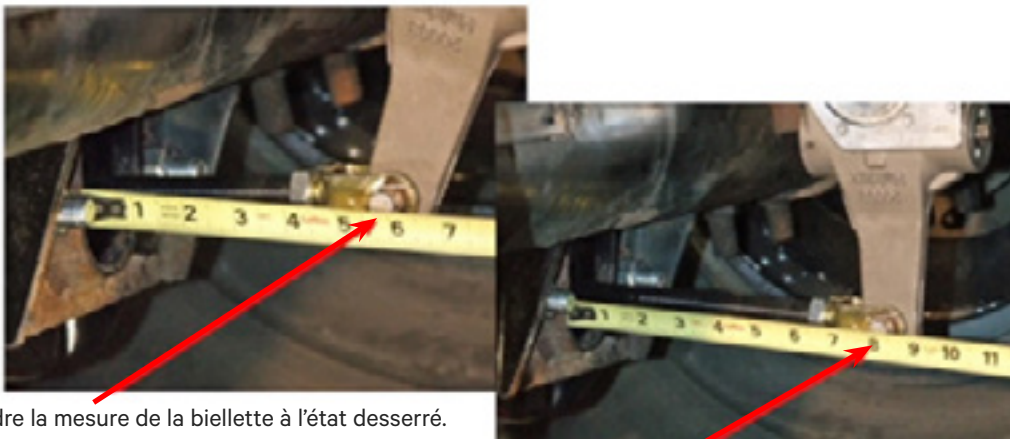
Figure 37 – Mesure de la course du rattrapeur d'usure Haldex
