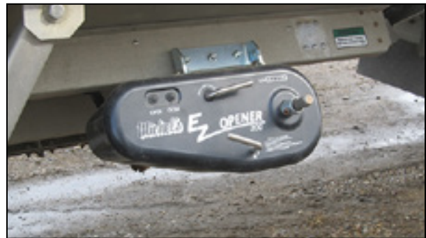
Figure 16 – Trappe de déchargement électrique
