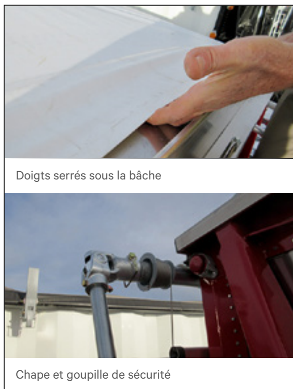
Figure 55 – Tension de la bâche
