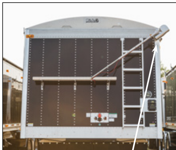
Figure 23 – Moteur électrique de la bâche
