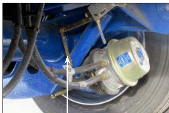
Figure 38 – Mécanisme de réglage de la hauteur de circulation
