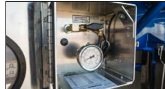
Figure 15 – Boîtier du manomètre à air
