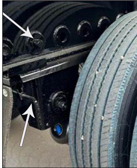
Figure 34 - Goupille de blocage et levier de dégagement des goupilles de blocage
