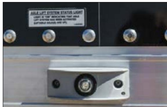
Figure 26 – Voyant et autocollant du système d'essieu relevable
