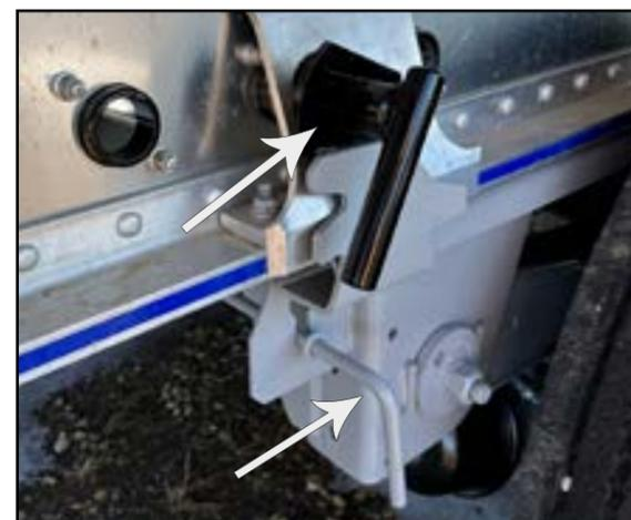
Figure 31 - Guide de positionnement avec col de retenue et levier de dégagement des goupilles de blocage
