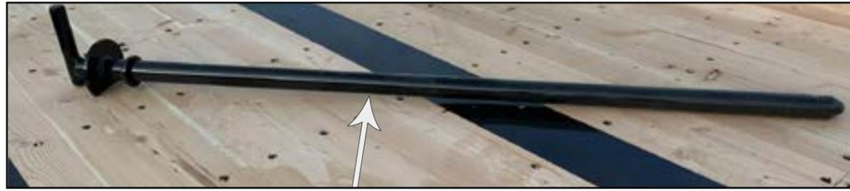
Figure 32 - Guide de positionnement du train coulissant
