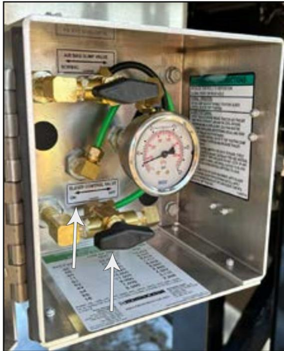
Figure 33 - Valve de commande du train coulissant et autocollant
