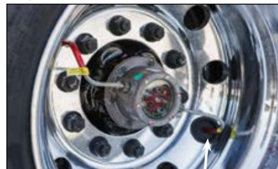
Figure 21 – Flexibles de gonflage des pneus
