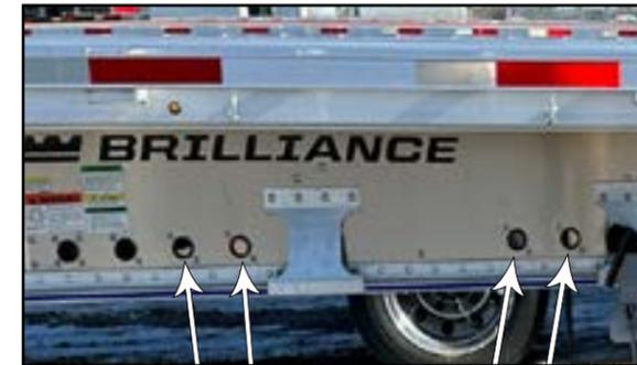
Figure 30 - Trous de positionnement du train coulissant
