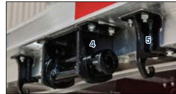
Figure 19 – Treuil et crochet en J
